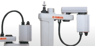
벽 취부 타입 로봇 본체를 벽면에 설치하는 타입 인버서 타입 벽 취부 타입을 거꾸로 한 타입
