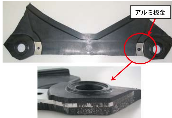
図4-7 ボトムカウルの金具インサート
